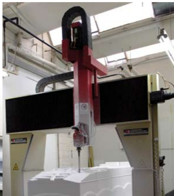
Bearbeitung leichter Schaummodelle.
