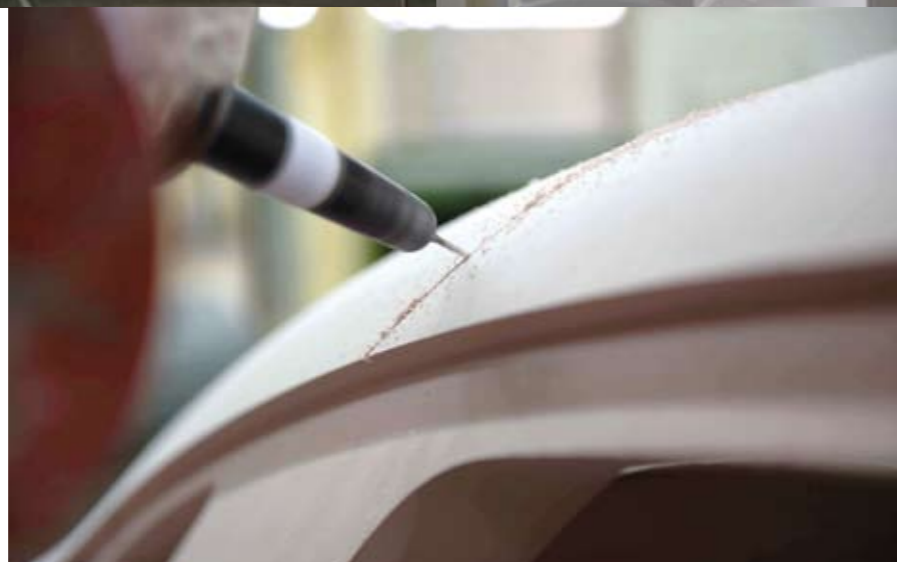
Konturnaher Verguss – Bearbeitung der kleinen Radien.
